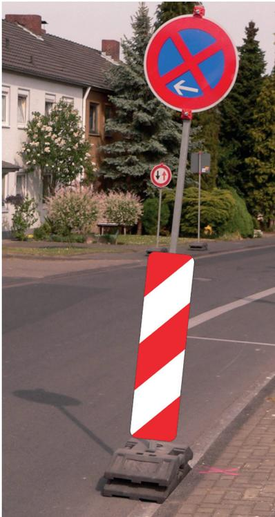
Bild 11 | Soweit die Breite für Geh- oder Radweg im Seitenraum nicht ausreichend ist, können Schilder im Einzelfall am rechten Rand der Fahrbahn aufgestellt werden. Eine Absicherung durch eine Bake ist erforderlich.
